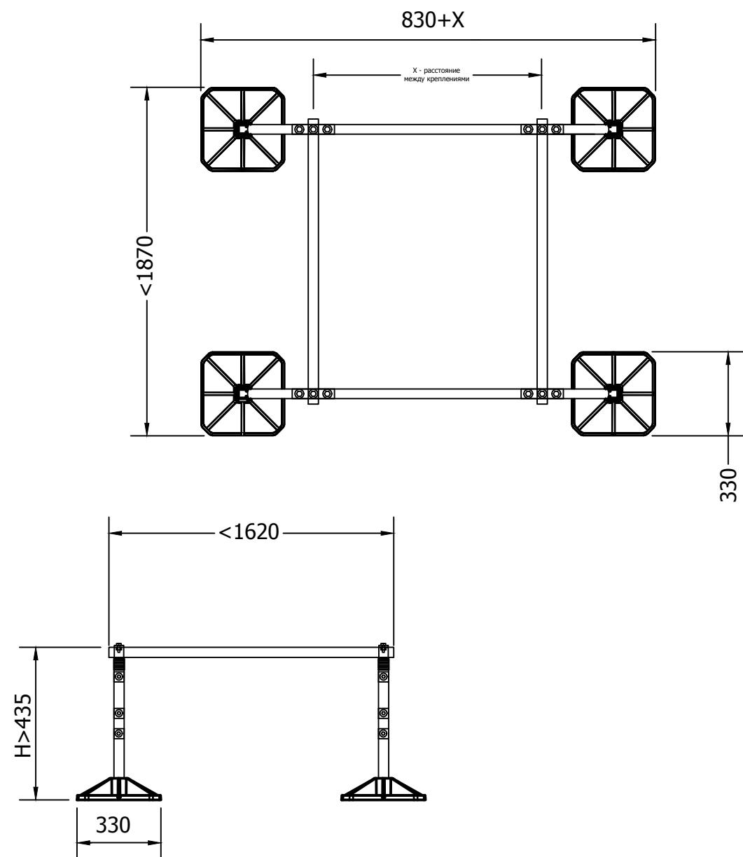
Н - Высота регулируется длинной профиля. Будьте внимательны при резке профиля! Стойки должны быть одинаковыми и ровными.
