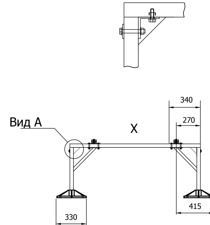
X - Расстояние между узлами креплений относительно рамы регулируется длинной профиля. Конечный размер рамы фиксируйте исходя из тех. спецификации устанавливаемого оборудования.
