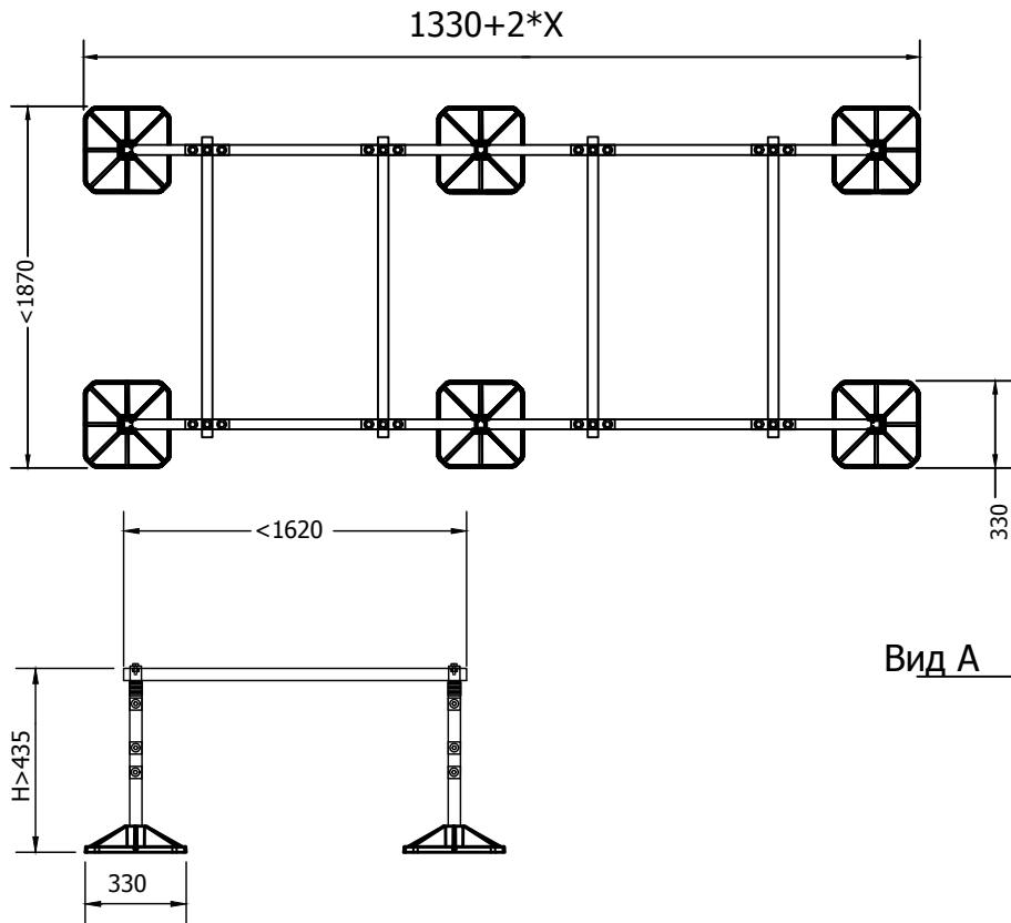
Н - Высота регулируется длинной профиля. Будьте внимательны при резке профиля! Стойки должны быть одинаковыми и ровными.
