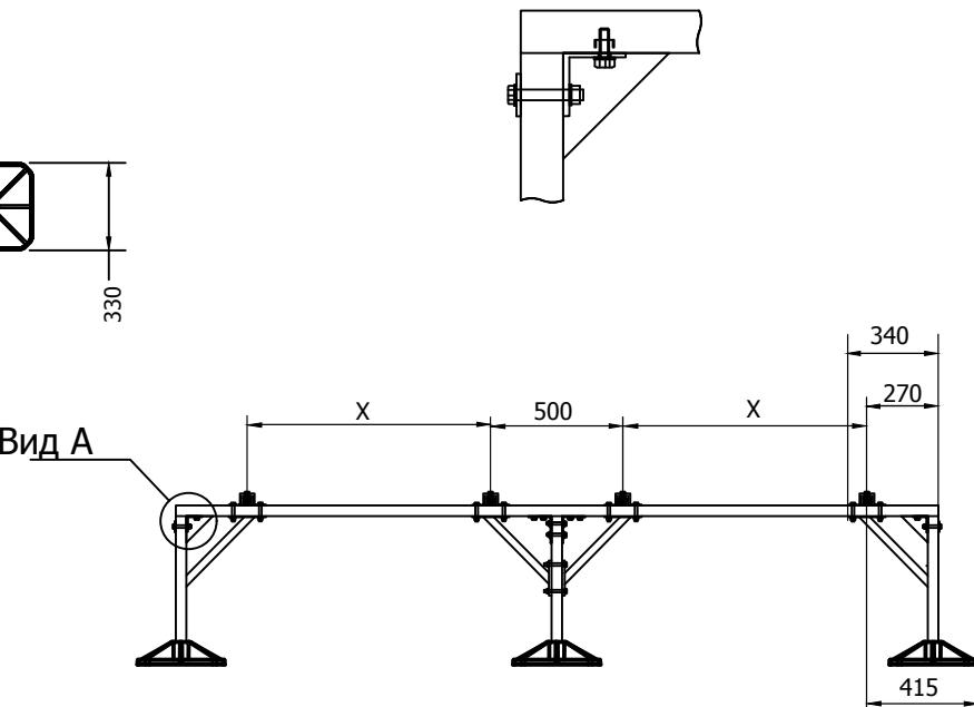
Х - Расстояние между узлами креплений относительно рамы регулируется длинной профиля. Конечный размер рамы фиксируйте исходя из тех. спецификации устанавливаемого оборудования.
